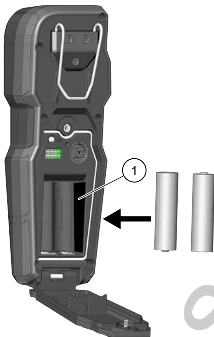
Figura 1. Instalação de baterias do controle remoto
