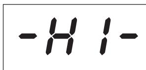
Se il carico applicato al sensore supera la capacità massima dell'apparecchio del 10% (esempio: un 1 t caricato a 1.1 t), il display indica un messaggio di stato di sovraccarico « – HI – » rappresentato qui a lato.
