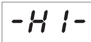
Quando a carga aplicada ao sensor exceder de 10% a capacidade máxima do aparelho (ex : um 1 t carregado a 1.1 t), a caixa de visualização indica uma mensagem de estado de sobrecarga « - HI - » representada aqui ao lado.
