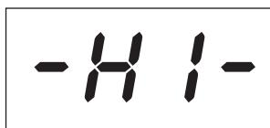
Cuando la carga aplicada al sensor rebasa la capacidad máxima del aparato en 10% (ej.: un 1 t cargado con 1.1 t), el módulo de visualización indica un mensaje de estado de sobrecarga « – HI – » representado al lado.
