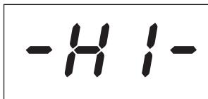
Om belastningen på givaren överstiger apparatens max bärformåga med 10% (t. ex.: en 1 t lastad till 1.1 t) visar displaydosan ett statusmeddelande om överbelastning " – HI – " enligt vidstående bild.
