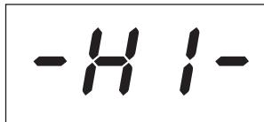
Lorsque la charge appliquée au capteur dépasse la capacité maximale de l'appareil de 10% (ex : un 1 t chargé à 1.1 t) le boîtier d'affichage indique un message d'état de surcharge « - HI - » représenté ci-contre.
