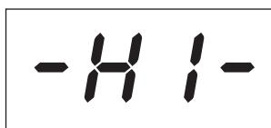
Wenn die auf das Messgerät wirkende Belastung den Messbereich des Geräts um 10% übersteigt (z. B.: 1.1 t an einem 1 t-Gerät), zeigt der Monitor die Überlastmeldung „- HI –“ an.
