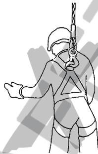
Schweißarbeiten am Hubwerk, der Seiltrommel und dem Seil sind verboten. Das Seil darf nicht als Erdleitung bei Schweißarbeiten verwendet werden.
