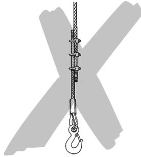
Das lose Zugseilende darf nicht zum Anschlagen von Lasten verwendet werden.
